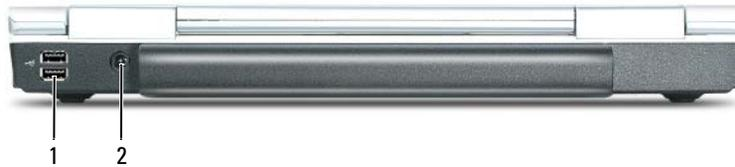
1 USB-Anschlüsse (2)      2 Netzteilanschluss
