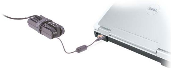
**⚠ VORSICHT:** Das Netzteil funktioniert mit allen Steckdosen weltweit. Die Stecker oder Steckdosenleisten können jedoch unterschiedlich sein. Wird ein falsches Kabel verwendet oder dieses nicht ordnungsgemäß an die Steckerleiste oder die Steckdose angeschlossen, können ein Brand oder Schäden im System verursacht werden.
